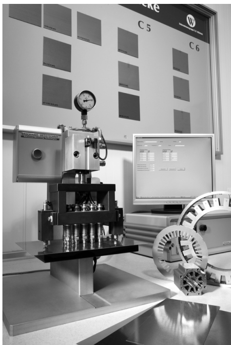
Bild 8: Prüfung des Isolationswiderstandes gem. ASTM A717[5]
